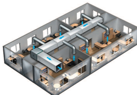
Вариант применения вентилятора ВШ в офисном помещении
