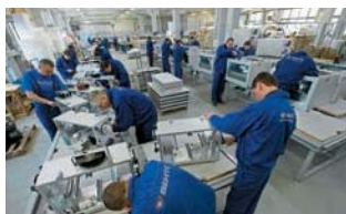
Цех изготовления приточно-вытяжных установок
