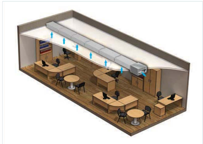
Вариант применения вентилятора ВКПФИ в офисном помещении
